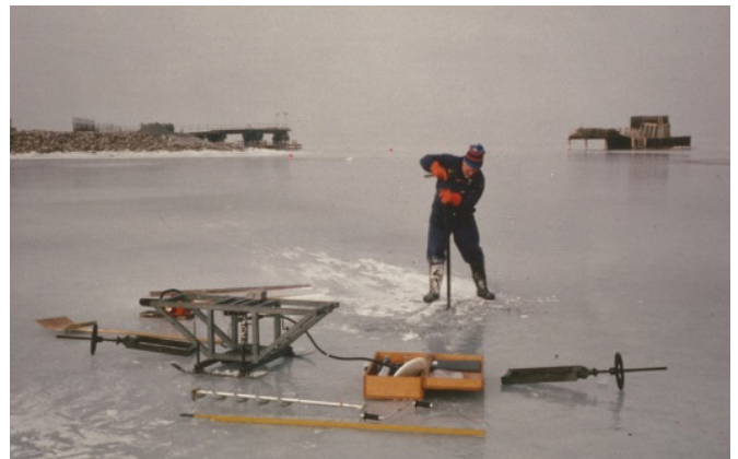
Is-undersøgelse ved Farøbroerne, februar 1982 (bøjningsstyrke r_f ) 10
